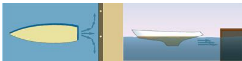
Rys. 3b. Jacht podchodzący do nabrzeża o budowie zamkniętej, która blokuje przepływ wody wywołany działaniem napędu jachtu / rys. J. Buczek
